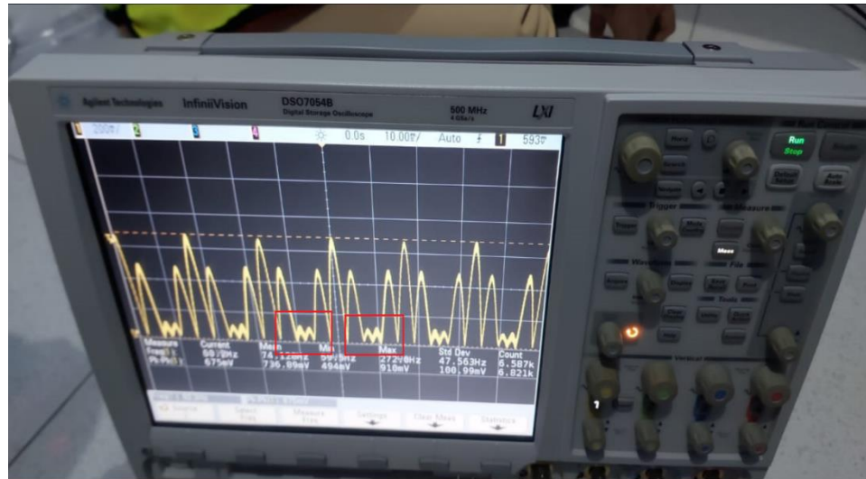
Gambar 3. 46 sinyal five finger tidak normal di oscilloscope Sumber: Dokumentasi Penulis, 2023
