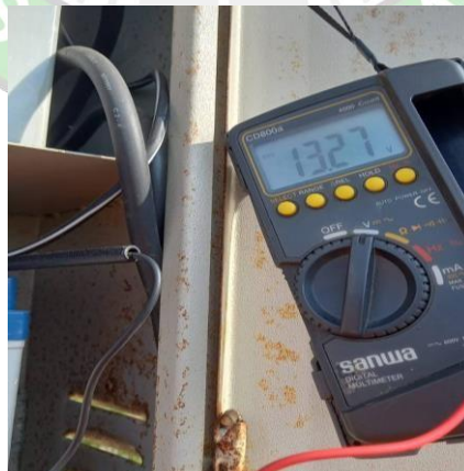
Gambar 4. 9 Hasil Pengecekan Baterai saat Perbaikan
