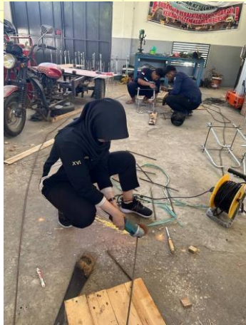
Pengelasan Pondasi PJU Panel Surya
