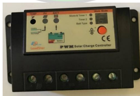
Gambar 3. 5 Solar Charger Controller Sumber: Data Pribadi Penulis
