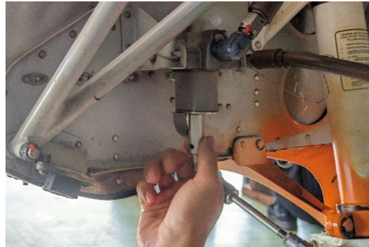
Gambar 4. 15 Pelepasan standpipe setelah bowl terlepas
