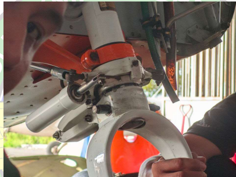
Gambar 4. 8 Kondisi setelah pemasangan shimmy damper pada shock strut
