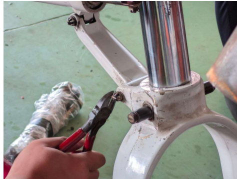
Gambar 4. 7 Pemasangan lock pin atau cotter pin pada castle nut torque links
