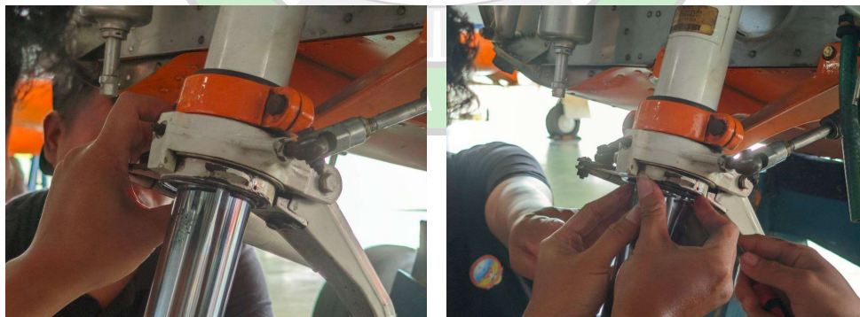
Gambar 4. 6 Pemasangan lock ring pada alur ujung bawah pada top strut
