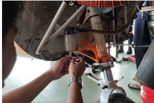
Gambar 4. 13 Pelepasan safety wire pada fuel strainer
