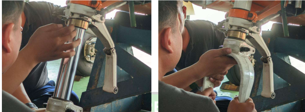
Gambar 4. 5 Instalasi bottom strut pada top strut
