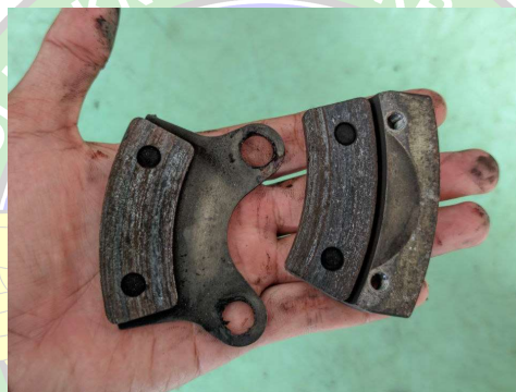
Gambar 4. 10 Kondisi brake lining dan back plate setelah proses dissassembly
