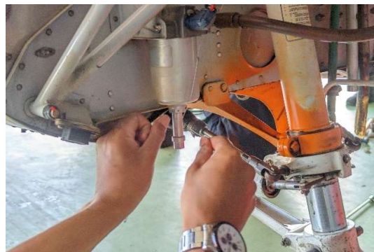
Gambar 4. 18 Pemasangan safety wire
