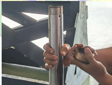
Gambar 4. 3 Pelepasan Bearing pada ujung atas dari Bottom Strut
