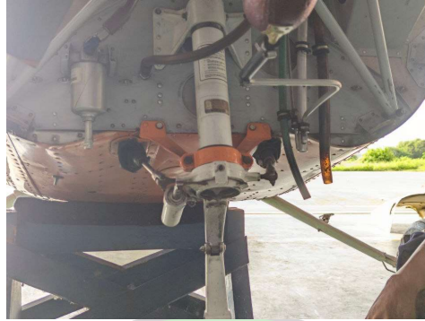
Gambar 4. 2 Kondisi setelah bottom strut terpisah dengan top strut
