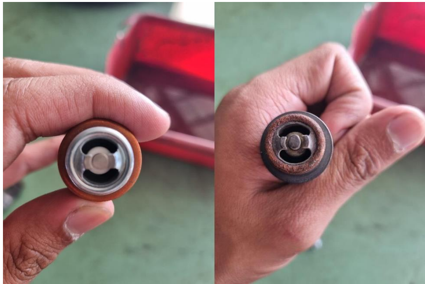
Gambar 4. 8 : Perbandingan spark plug yang weak dengan yang serviseable
