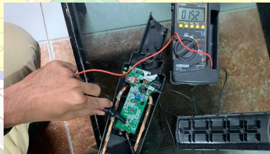
Gambar 3.20 Modul Hand Held Metal Detector Sumber : Dokumentasi Penulis, 2024
