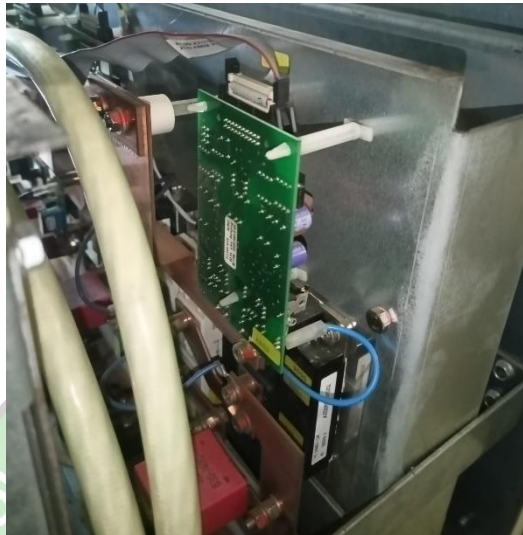
Gambar 4. 15 Penggantian IGBT Driver Sumber: Penulis
