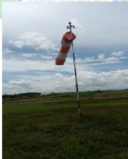
Gambar 2. 36 Wind Direction Indicator Sumber : Dokumentasi Penulis
