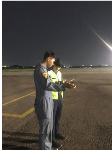
Gambar 4. 4 Pengukuran Intensitas Cahaya dengan Lux Meter Sumber: Dokumentasi pribadi
