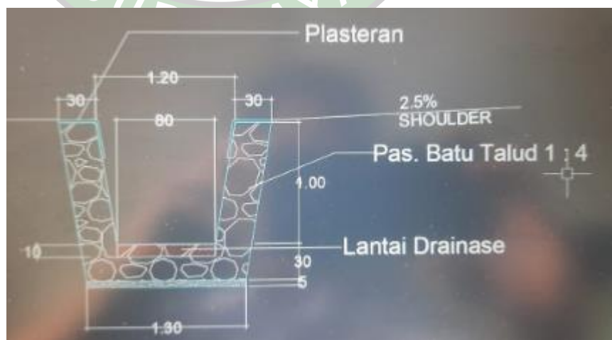
Gambar 4.16 Desain Bentuk dan Ukuran Drainase
