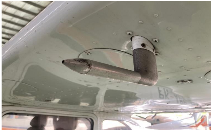
Gambar 4.10 Penyumbatan pada Pitot Tube
