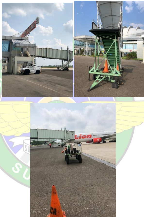
3. 1 GSE yang tidak diletakkan pada tempatnya
