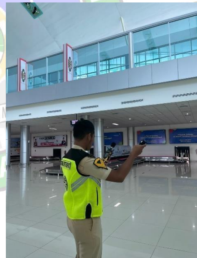
Pengecekan suhu dan kebisingan pada terminal
