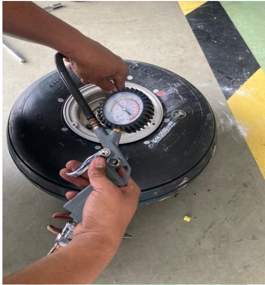
Gambar 4. 12 Pengecekan Presseure pada Tire
