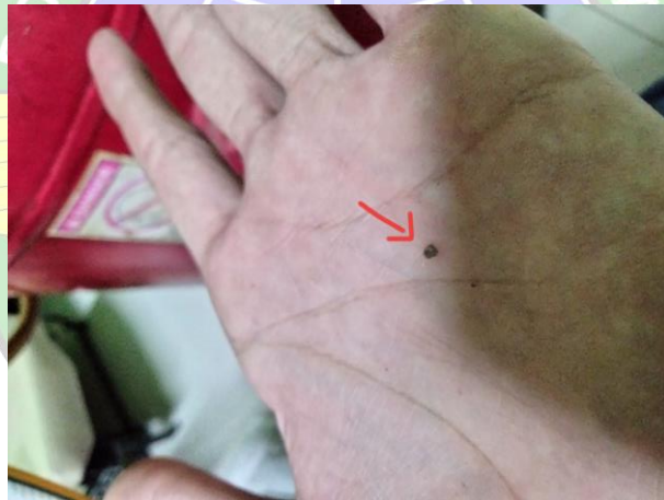
Gambar 4. 18 Ditemukan batu kecil Ketika selesai membersihkan pitot dengan compressor
