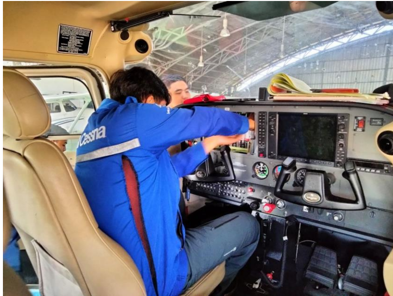
Gambar 4. 17 Engineer memastikan pitot line terhubung dengan airspeed standby instrument
