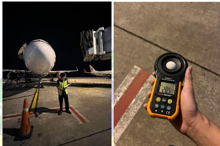
Gambar 4. 6 Pengukuran Intensitas Cahaya Dengan Lux Meter Sumber : Dokumentasi Penulis, 2024
