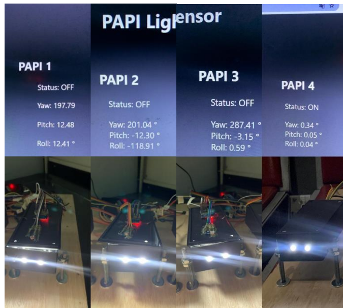
Gambar 4. 13 Uji Coba Prototype Tanpa Kalibrasi Kaki Pada PAPI Prototype
