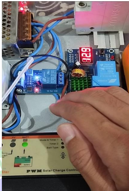
Gambar 4. 11 Simulasi Relay Module XH-M131 Sumber : Penulis, 2023
