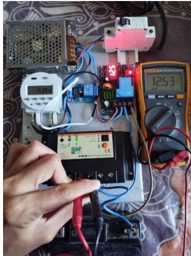
Gambar 4. 9 Pengukuran Tegangan Baterai Sumber : Penulis, 2023
