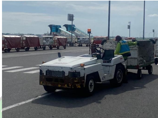
Gambar 4.7 BTT dengan cat yang memudar dan berkarat
