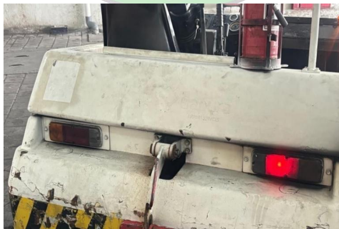
Gambar 4.9 kondisi BTT dengan lampu pengereman bagian kiri tidak berfungsi
