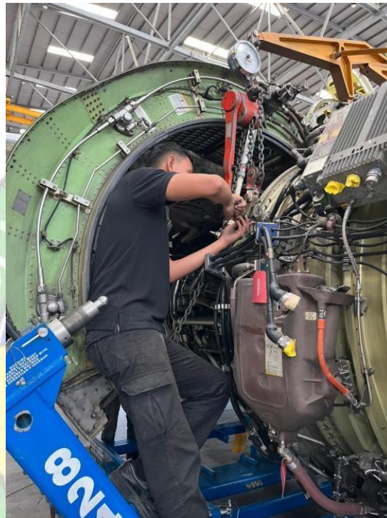
Gambar 3. 8 Instal lever hoist untuk menaikkan engine pada pylon
