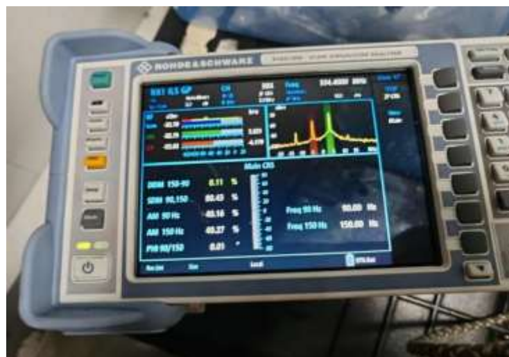
Gambar 3. 23 Display Portable ILS Receiver Sumber : Dokumentasi Penulis 2025
