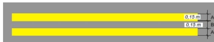
Gambar 3. 3 Marka Apron Edge
