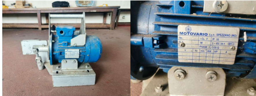
Gambar 3. 5 Motor Listrik Beserta Nameplate
