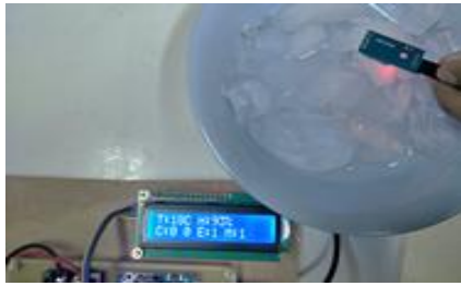
Gambar 6 Pengujian Sensor Kelembaban DHT 11 dengan Dingin Es Batu
